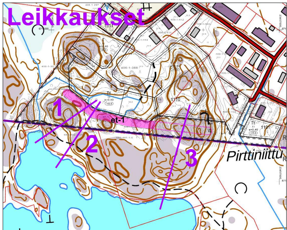
Havainnekuva läjitysalueen (et-1) ja maaston yhdessä muodostamasta suojausvaikutuksesta. Kuvaan on merkitty seuraavana esitetyt leikkaukset 1–3.
